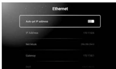
Conectar cable Ethernet y elegir la opción de descarga automática de dirección IP, para conectarse a través de la red Ethernet.
